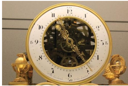
Mechaniczny zegar z balansem i wychwytem kotwicznym
