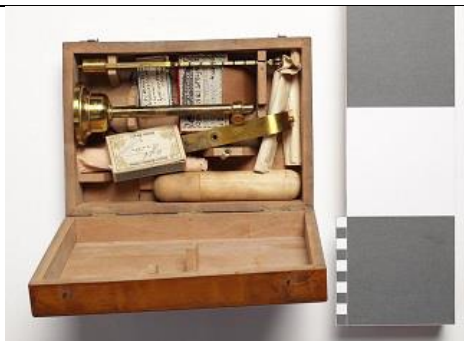
Waga hydrostatyczna; wytw. Fabryka Wag August SAUTER; Ebingen, Niemcy; 1900 r.
