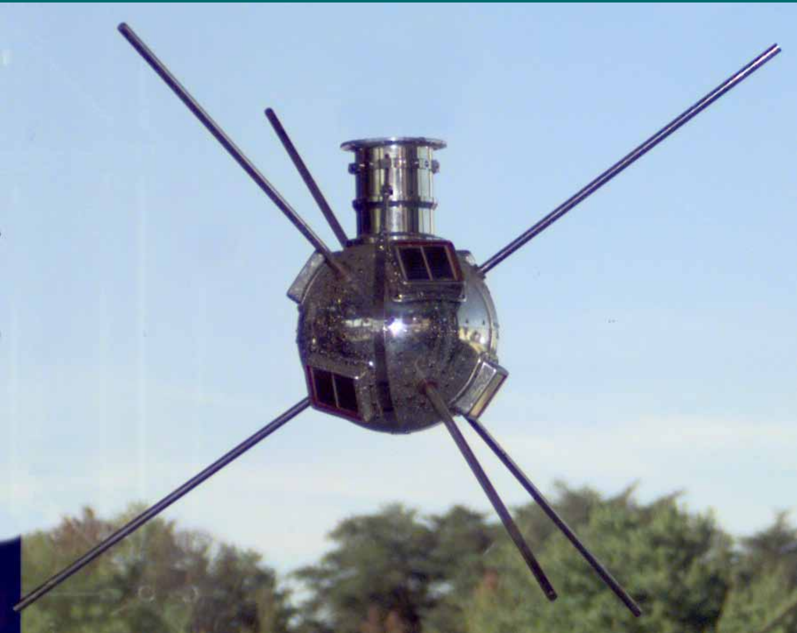
Satelita Vanguard 1C. Średnica 16,5 cm, masa 1,46 kg
