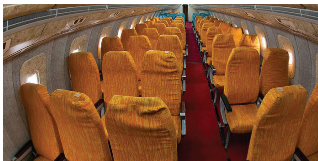
Tu-144, kabina pasażerska. W jednym rzędzie znalazło się miejsce na 5 foteli.
