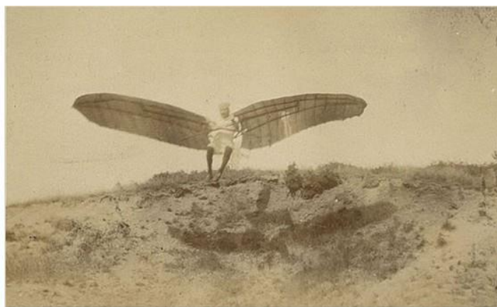
Derwitzer Apparat. Rozpiętość skrzydeł 7,6 m, masa 18 kg.
